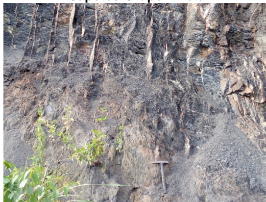
Fotografía 5-71 Azimut 170. Detalle del diaclasamiento perpendicular en la Formación Capotes-Grupo Villeta
