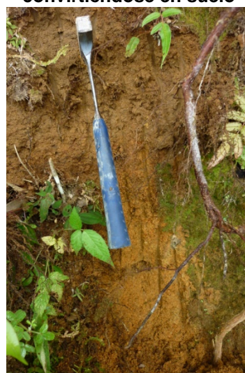
Fotografía 5-39 Costado derecho de la vía que conduce a la torre proyectada N° 138, en donde se identifica la presencia de matriz de ceniza de color marrón, de granulometría predominante limo – arenosa, en estado avanzado de desintegración convirtiéndose en suelo
